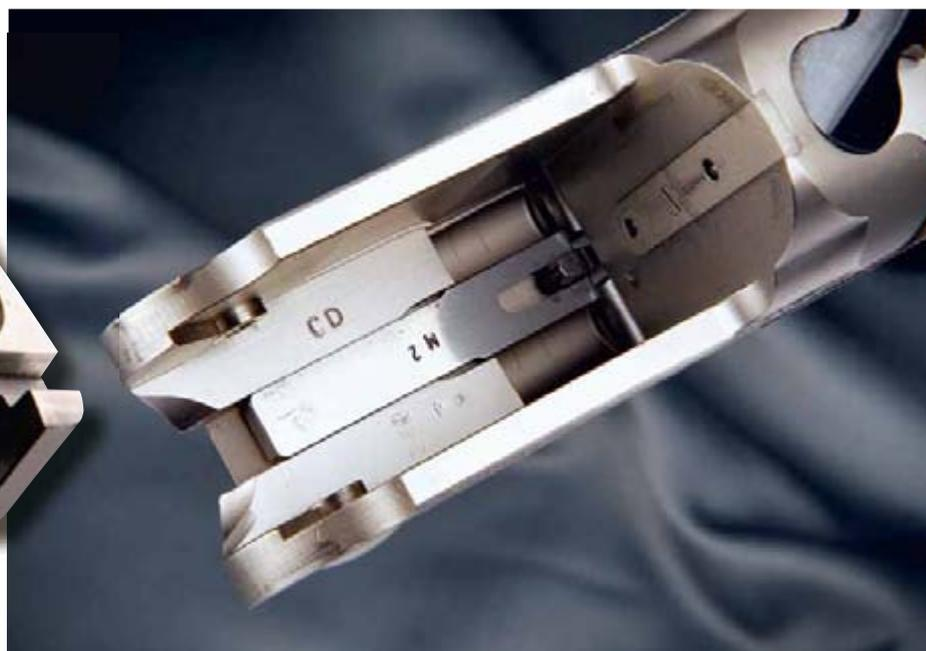
Sopra: l'organizzazione meccanica è ordinata. Nella zona maggiormente sottoposta all'erosione la piastrina in acciaio che rinforza la bascula in Ergal. Bascula macchinata da trafilato in lega di alluminio ad alta resistenza 7075/T6. I perni di basculaggio sono in acciaio e intercambiabili.
