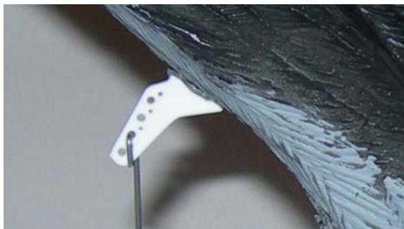
7) Con il fil di ferro ( consiglio quello di acciaio usato in modellismo) ricavare il tirante tra la bielletta del motore e la squadretta posta sotto la coda. Alimentare il motorino e controllare le escursioni dello stampo.
