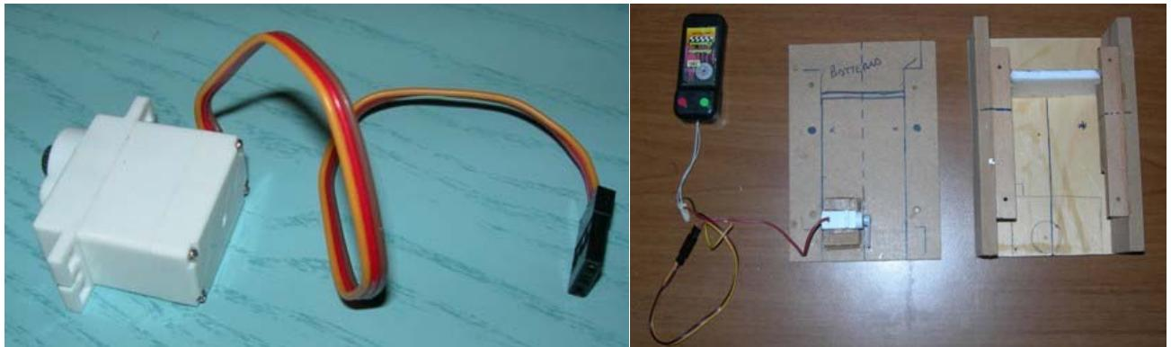
5) Prima di chiudere con il coperchio superiore ( quello dove si innesteranno le "zampe" ) controllare il movimento della biella del servo che non dovrà toccare, durante la sua rotazione, sia in alto che in basso e che il porta batterie non interferisca con il resto.
